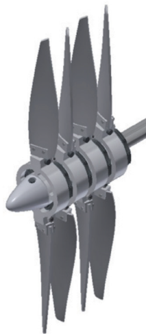
4重反転プロペラ電動推進システム概念図および試作装置
