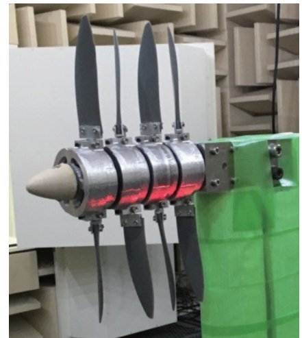
4重反転プロペラ電動推進システム概念図および試作装置
