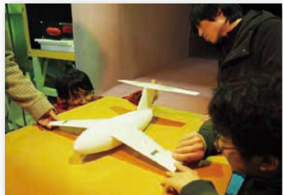
●地面効果翼機(WIG)の風洞実験
