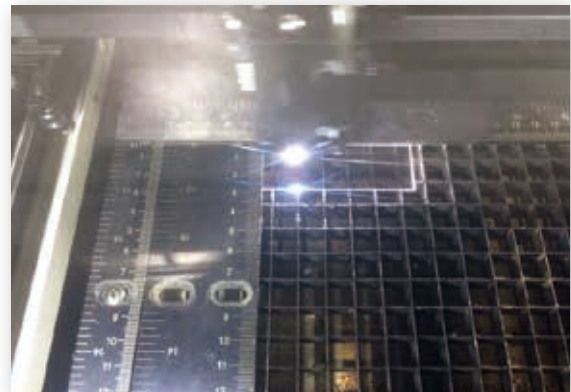
●ガラス材料のレーザー微細加工
