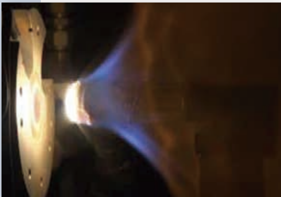
●地球再突入環境での耐熱材料加熱試験
