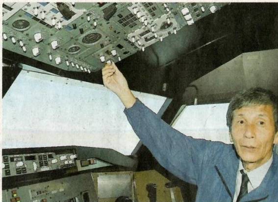
ジェット機のシミュレーターで、操縦室上部にあるドアロックのつまみを示す前田岳夫教授＝崇城大の空港キャンパス
