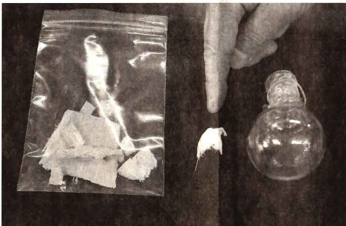
FRP（左）から分離したガラス繊維（中央）と液体状プラスチック
