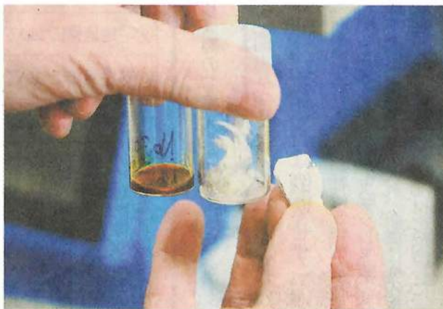
破壊されたバスタブの破片（写真右）から分解して取り出されたガラス繊維（同中）とプラスチック（同左）
