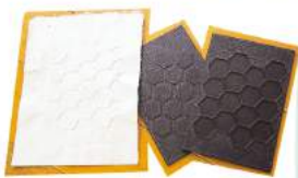
亀甲模様が浮き彫りになった和紙（右は3Dプリンターで作った型枠）
