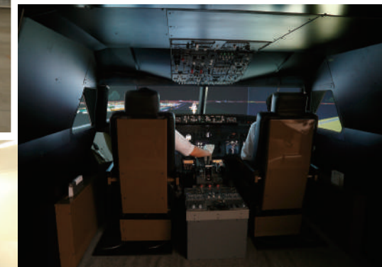
●北ウイング施設内にあるボーイング 737 型機を模した FTD (Flight Training Device)。この FTD は全ての資格取得修了後、エアラインでの飛行機の飛ばし方を学ぶため、操縦士 2 人 (機長と副操縦士) による運航を教育するために使用される。
