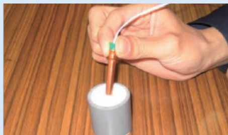
容器内の爆薬を起爆用の電気雷管で発破すると瞬時に加工・成形できる
