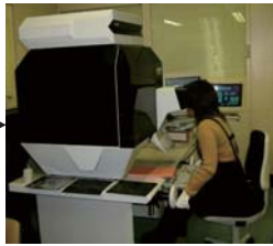
「図化機」を用いて人の手で地形図を描き出す
