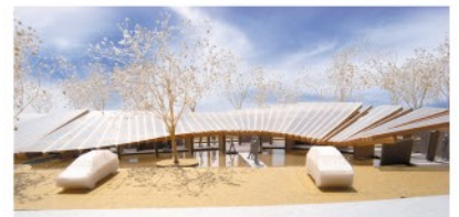
内田研究室で作成・提出した熊本県・立山憩の森に新たに設置する公衆トイレのデザインコンペ作品。半透明の素材で覆った3次曲面の屋根、人の動線をコントロールする水盤、熊本県産の木材を使った壁面などで構成されています。
