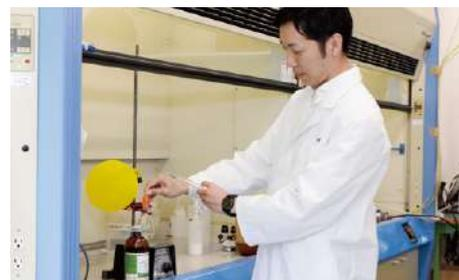
攪拌子を回転させながら薬品を混ぜ合わせる様子
