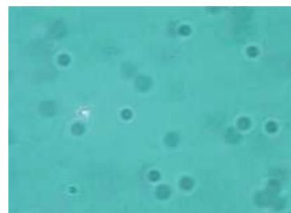
水中に分散した粒子(直径1μm)を集光レーザーで捕まえた様子 ※中右左寄りに見える白い点がレーザー光の集光場所で、そこに数個の粒子が捕まっている。
