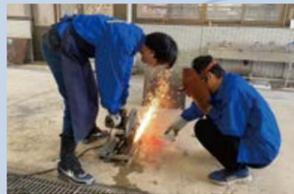
溶接した試料を切断する様子
